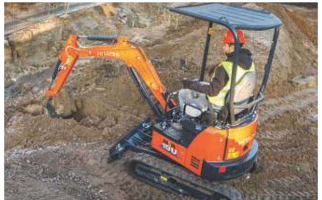
Die 3-Säulen-Schutzdachkonstruktion bietet optimale Sicht.
