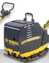
BPR 45/55 D Betriebsgewicht: 400 kg Zentrifugalkraft: 45 kN Arbeitsbreite: 550 mm
